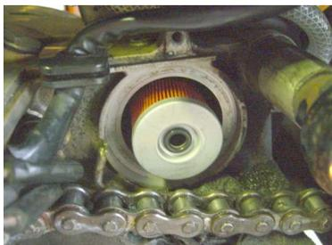
③フィルターが取り付けると、この様に周辺と均等に隙間を保持して水平に自立するようになる。(左図参照)
