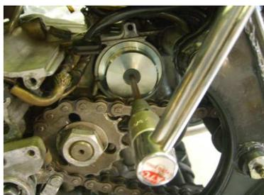
④M8サラボルトを取り付ける。トルクレンチを用い、2. 0kg・mで締め付ける。
