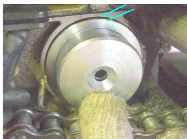
②カバーが周辺より1mmほど浮き、隙間が出来て、オイルフィルターの中心のリングに締め代があることを確認する。
