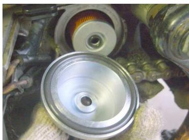
③カバーにリングを入れ、セットする。リングがずれる場合は、リングにグリースを薄く塗布してからカバー溝に入れると脱落せずセットしやすい。
