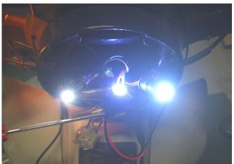
11. 3個のLED電球を取付け、キーONし、点灯を確認します。LEDは極性があります。LED球のマイナス側にマジックで線が書いてあります。Ba7Sはそのまま取り付けます。ニュートラルは黒線が+、ウインカーはウインカーアダプターケーブルの赤線が+です。点灯しない場合は接続を確認します。
