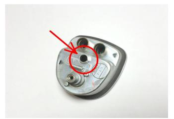
3. メーターは取り外さなくてもOKで、車体に取り付けえたまま作業できます。赤丸の部分がメーター照明用Ba7S取付部です。電球ソケットを回して脱着します。
