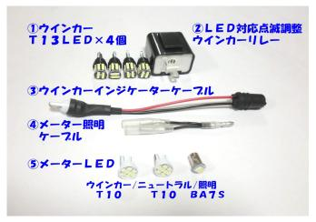
1. 部品を確認します。LED球は+, -の極性があります。マイナス側にマジックで線が引いてあります。説明書の「カブ系電装配線図」で取り付け部分を確認しておきます。うまく動作しない場合は、配線図を確認します。
