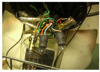
6. メーターから電球を取り出します。左から、メーター 照明、ウインカー、ニュートラルです。メーター照明は回 して押し込むと引っ掛かりが外せます。ウインカー、 ニュートラルはゴムで差してあるだけです。
