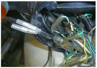
9. キーONで直流+12Vが来る黒線に、照明分岐ケーブルを取り付けます。
