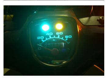
12. 3個の電球をメーターに取付け、動作を確認します。この他、ウインカーの電球とリレーを交換します。リレーは、右サイドカバー内にあります。次にウインカー内の電球をT13 LED 4個と交換します。電球をセットしたら、かならず動作確認をします。点灯しない場合は電球の向きを変え極性を入れ替えます。リレー下部に点滅速度調整マイナス溝がありますので点滅速度を調整します。
