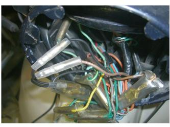
10. 照明分岐コネクターの2つのメスギボシにそれぞれ照明への茶線と外した黒線を接続します。ウインカーアダプターケーブルも取り付けておきます。元の車体側ウインカーソケットに、延長ケーブルを差し込んでおきます。
