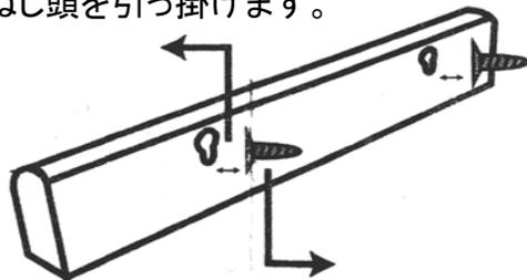
① ねじを少し浮かして壁に取り付けます。
