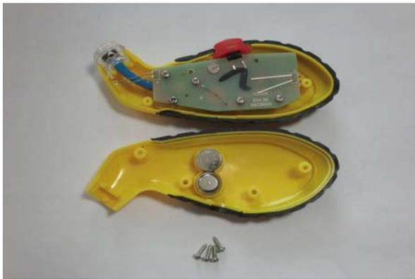
④基盤の裏にさらにLR44 × 2個があります。基板の3本のネジを外して基板を外します。
