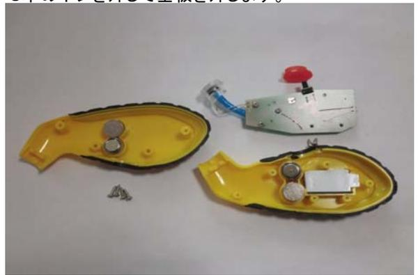
⑤基盤を外すときは、LEDが液晶基板に引っかかっていますので注意して外します。
